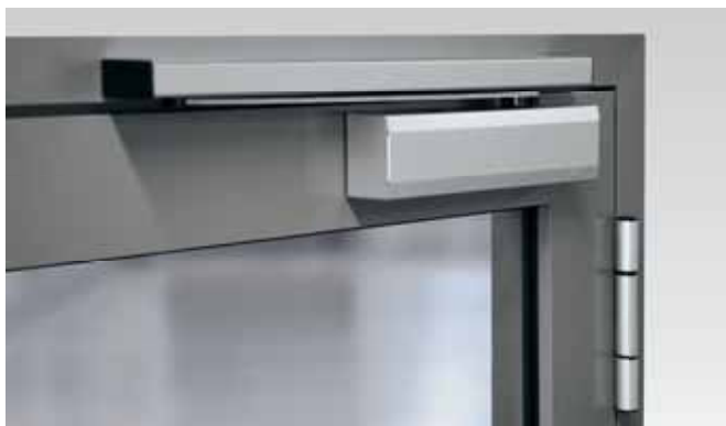
Новая серия OTS 73x: одна скользящая шина, одна скользящая тяга, один удлинитель оси и одна монтажная пластина для всех видов монтажа и областей применения
